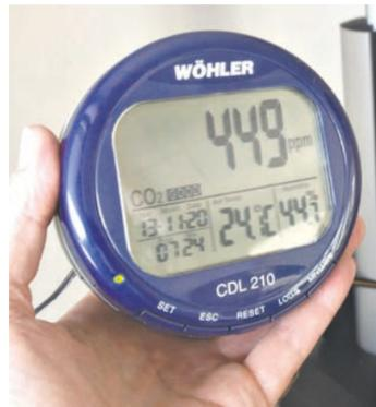
CO<sub>2</sub>, relative Luftfeuchtigkeit und Temperatur werden gleichzeitig auf einem großen Display angezeigt.
