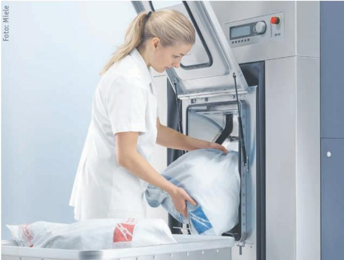
**Hygienisch: Die Aufbereitung von möglicherweise kontaminierten Textilien in Wicksäcken, die sich während des Waschprozesses automatisch öffnen.**
