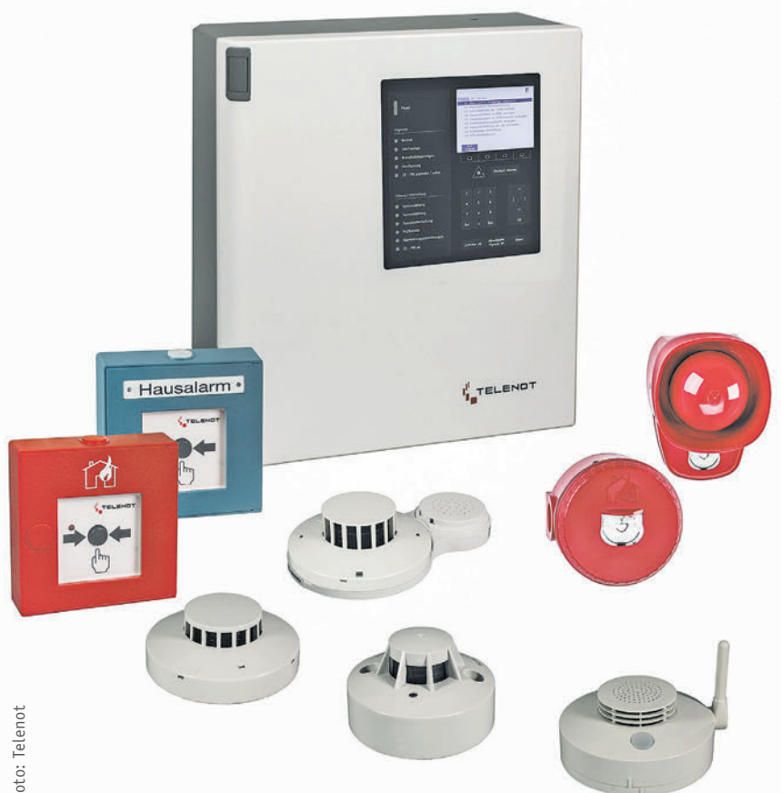
Das Herzstück: die Brandmeldezentrale hifire 4400 ist modular aufgebaut. Vier Loops geben die Möglichkeit, ein breit aufgestelltes Melderportfolio anzubinden.
