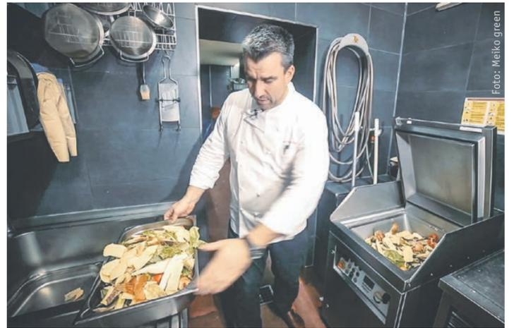
**Ganz einfach: Die Essensreste werden in die Eingabestation gegeben, Deckel zu, Knopf drücken. Im Handumdrehen wird alles vollautomatisch zu einer Biomasse zerkleinert und in Tanks transportiert.**
