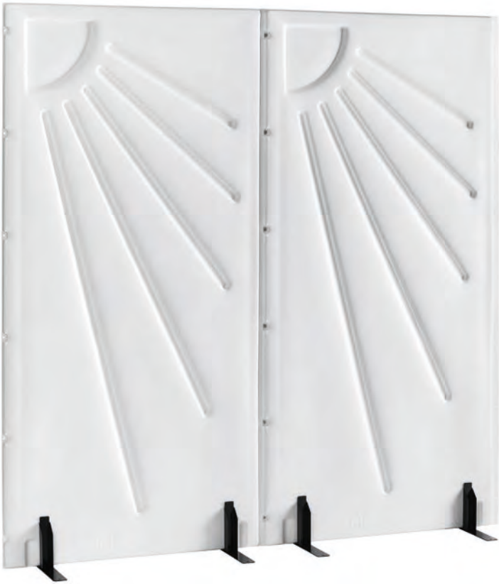
Infektionsschutzwand mit antimikrobieller Wirkung: Dafür wird beim Herstellungsprozess des Kunststoffes ein spezielles Additiv auf Basis von Silberionen beigemischt. Die Nanopartikel aus Silber haben die Eigenschaft, das Wachstum von Mikroorganismen wie Viren und Bakterien zu hemmen. Bis zu 99 Prozent der Keime lassen sich dadurch auf der Oberfläche der Trennwand beseitigen.
